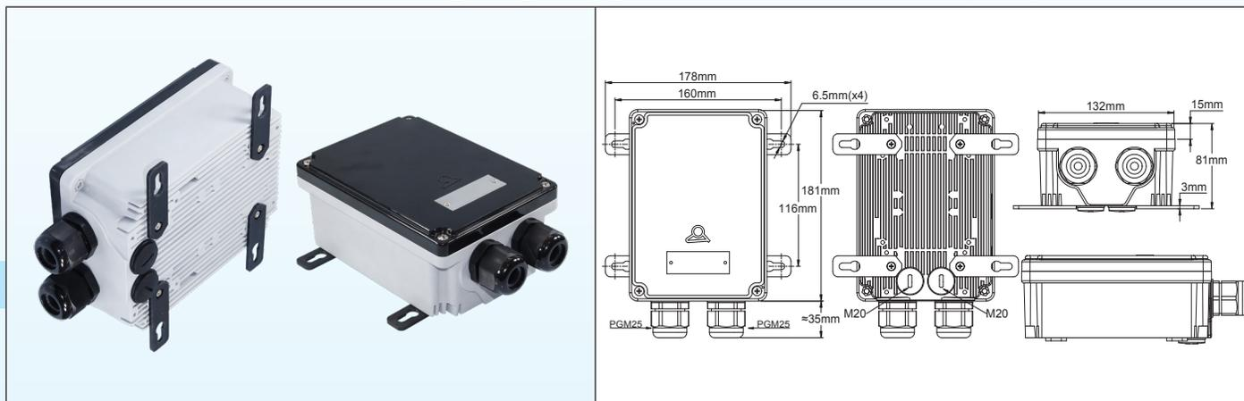
Diese versiegelten Aluminiumkästen sind RAL 7015 epoxid-lackiert. Sie haben die gleichen Abmessungen wie die Kunststoff-Regelkästen, und verwenden flache Deckel. Sie verwenden die gleichen Wandmontage-Laschen wie die Kunststoffmodelle. Sie sind für die Montage von 1- oder 3-phasigen Halbleiterrelais konzipiert, bei denen die Kühlung über die Rippen auf der Rückseite erfolgt.
