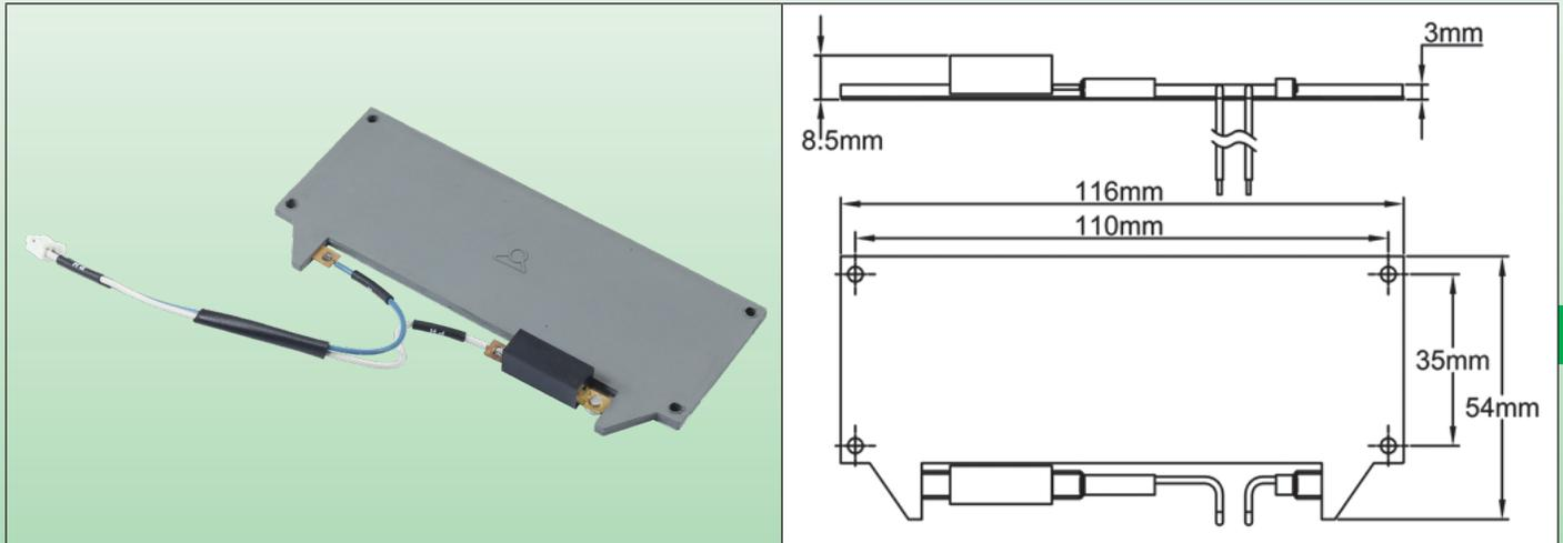
Unmittelbar unter dem transparenten Fenster verhindert der von ihm erzeugte warme Luftstrom die Kondensation auf dem Fenster und hält eine optimale Umgebungstemperatur für die Regelgeräte im Gehäuse. Ein breiter Aluminium-Wärmetauscher reduziert die Oberflächentemperatur und ein Miniatur-Schnappschalter-Thermostat begrenzt die Temperatur im Inneren des Gehäuses.
