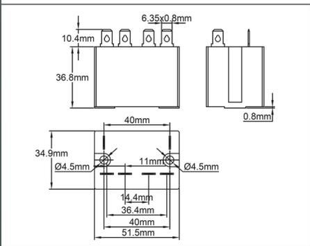
2 x 25A 250V ohmsch (AC1) (CE und UL) Schließer, versiegeltes Gehäuse, 6,35 x 0,8 Klemmen. Dieses Relais kann ohne Montageplatte direkt auf alle aus Kunststoff ausgelösten Fronten montiert werden, die für Kolben- und Kapillarthmostate und Elektronische Regler vorgesehen sind, sowie auf die flachen Fronten der Verteilerkästen in diesem Katalog. Spule 200-240V AC.
