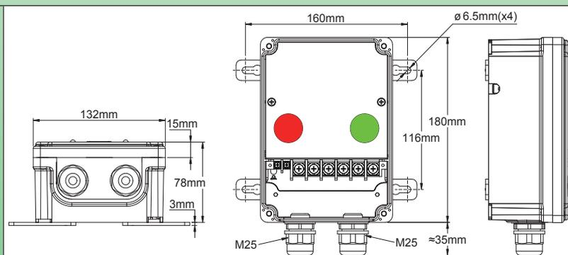
3 x 25A (AC1), 250V, Klemmenblock mit 2 Schraubklemmen 2,5mm<sup>2</sup> und 6 Schraubklemmen 10mm<sup>2</sup>. Rotes Kontrolllicht für Stromversorgung und grünes Ausgangslicht (250V), transparenter Deckel.
