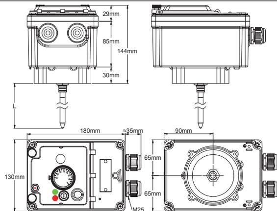
A: 1-Kolben-Modell, nur Temperaturregelung.
