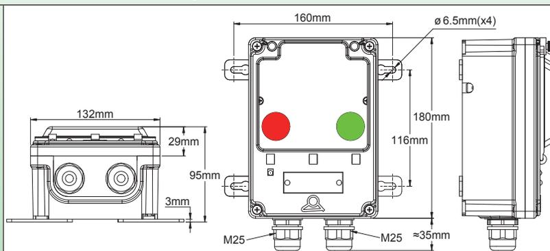
3 x 16A (AC1), 250V, Klemmenblock mit 5 Schraubklemmen 2,5mm<sup>2</sup> und 5 Schraubklemmen 6mm<sup>2</sup>. Rotes Kontrolllicht für Stromversorgung und grünes Ausgangslicht (250V), transparentes Fenster.
